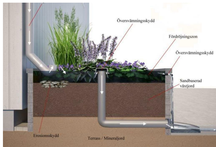
Dagvattenhantering i svackdike.
