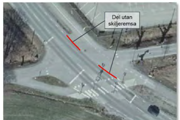
Figur 58. Del av korsningen med Björkuddsvägen som saknar skiljeremsa.
